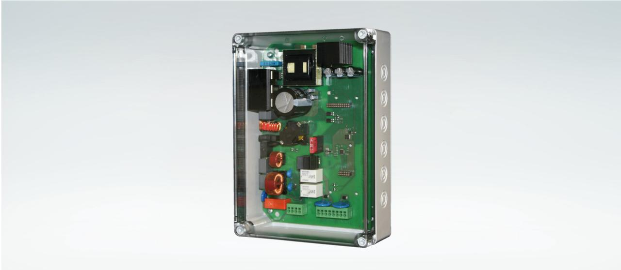
Lüftungszentrale zur Steuerung von 24 V DC Antrieben mit einer Stromaufnahme von bis zu 8 A.
